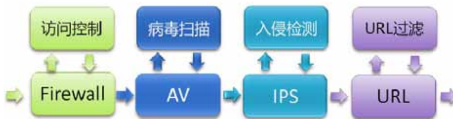
图1 传统UTM 串行软件处理架构
